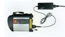
Ein vollständig abgeschlossener Formierungszyklus ist die Voraussetzung für einen störungsfreien Betrieb und den schnelleren, regulären Ladezyklus. Der jeweilige Ladezyklus wird im Display des SDconnect angezeigt:
