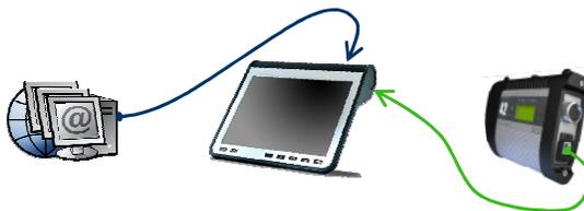
Am Star Diagnosis compact<sup>3</sup> w dient die **hintere LAN-Schnittstelle** ausschließlich zum **Anschluss an das Werkstattnetz/Internet**.
