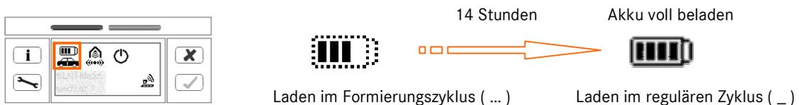
**Hinweis:** Stellen Sie vor dem Einsatz des Systems sicher, dass die Akkus beider Geräte (Star Diagnosis System und SDconnect) vollständig geladen sind!
